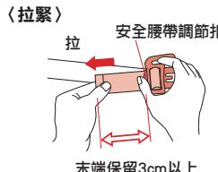
●輕壓安全腰帶調節扣，拉安全腰帶做長度調整。
