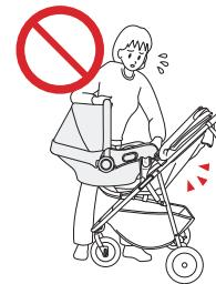
將兒童保護裝置安裝至嬰幼兒手推車時，請務必將嬰幼兒手推車的靠背調整至平躺狀態。
