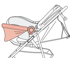
● 同時按住兒童保護裝置的旋轉按鈕（左右側），調整提把角度。
