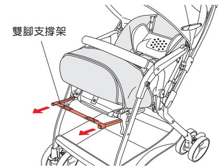
④ 將座墊下方的雙腳支撐架拉出。(左右)
