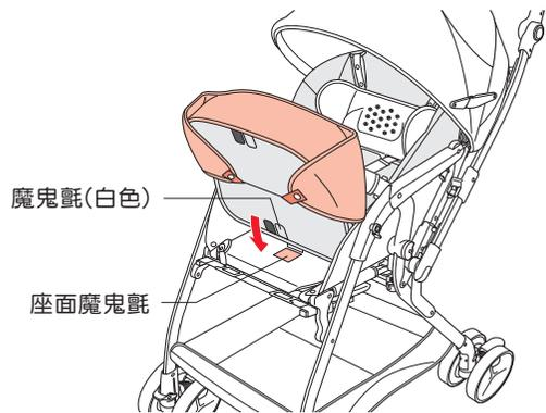
❺ 抬起座墊，調節墊往座椅內側反折，再將魔鬼氈(白色)與座面的魔鬼氈黏合。
