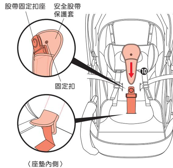
❻ 裝上股帶保護套，扣上固定扣。將股帶保護套的前端從座墊內側穿出。
