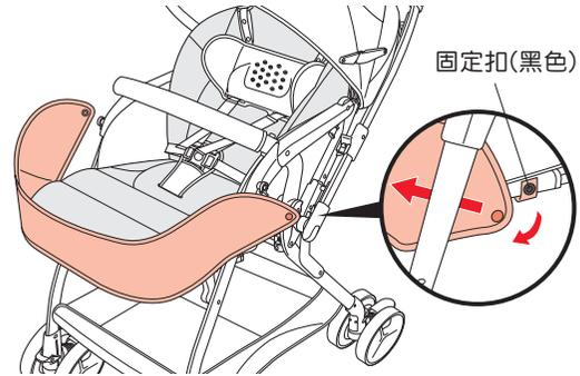
❷ 將腿部守護墊從本體座面側邊固定帶上的固定扣(黑色)拆下。(左右)
