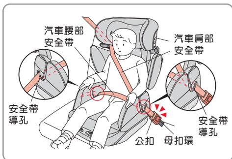
**5** 確認汽車的腰部安全帶沒有彎曲的情形後，將腰部安全帶穿過底座的安全帶導孔，並將其公扣插入母扣環內。
