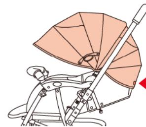
② 靠背往後躺時，將遮陽篷固定扣固定在頭枕後側的固定扣上。（左右）
