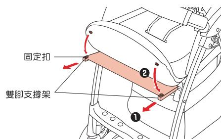
○雙腳支撐架適合於嬰兒睡覺時使用。增加座椅長度的功能。
