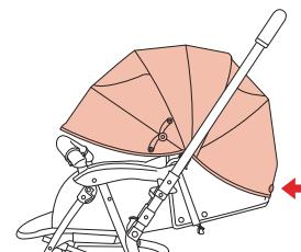
② 靠背往後躺時，將遮陽篷固定扣固定在頭枕後側的固定扣上。（左右）
