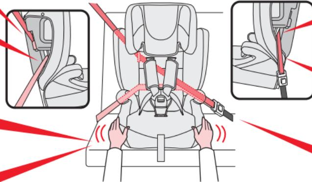
車輛安全帶穿過車輛安全帶引導溝槽。
