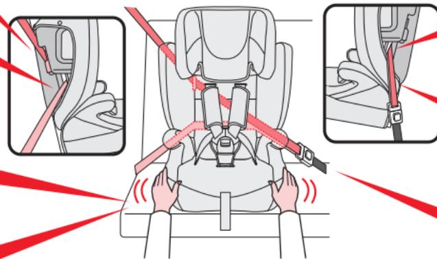
車輛安全帶穿過車輛安全帶引導溝槽。
